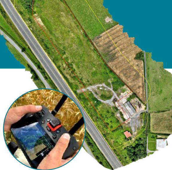
... de **créer des Modèles Numériques de Surface**. Il s'agit d'un complément pertinent à la délimitation des zones humides. Le relief du terrain est matérialisé et géolocalisé, facilitant ainsi la définition des limites des zones humides, généralement dépendantes de la microtopographie locale.
